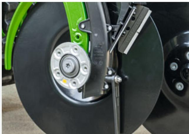
Il raschiatore interno in metallo duro per i suoli argillosi appiccicosi assicura un funzionamento ottimale del coltro
