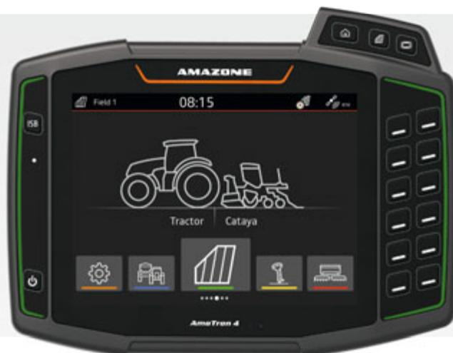
Il terminale di comando ISOBUS AmaTron 4, sviluppato internamente da AMAZONE, consente di controllare comodamente da tablet e con touch screen qualsiasi macchina agricola abilitata ISOBUS. AmaTron 4 consente di sfruttare tutte le funzionalità ISOBUS con maggiore comodità, facilità d'uso e visione d'insieme, ma si comporta ancor meglio insieme alle macchine agricole AMAZONE garantendo una funzionalità completa per il Precision Farming.
