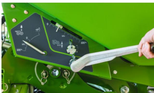
Regolazione meccanica centralizzata variabile all'infinito con scala di regolazione nella Cataya Super
