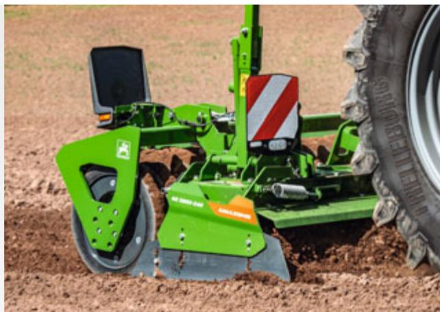
Erpice rotante KE 3002-240 Rotamix utilizzato da solo
