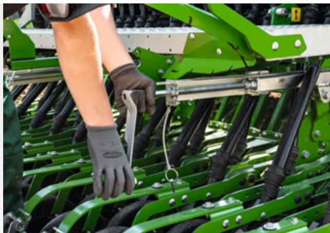
Facile regolazione della profondità di deposizione da destra e da sinistra sul lato posteriore della Cataya Special
